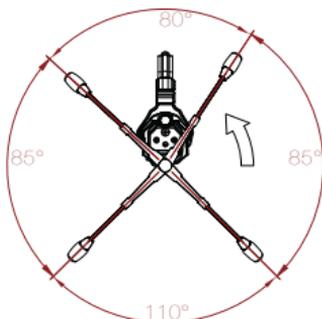
Stummschaltbereich des Mikrophons, wenn der Mikrofonarm gegen den Uhrzeigersinn nach unten bewegt wird
