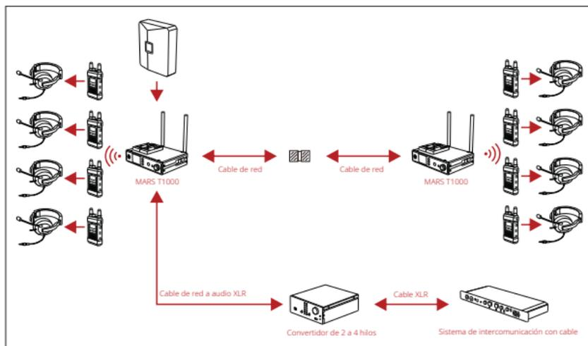
MARS T1000 con una interfaz de audio estándar de 4 hilos, que se puede conectar a diferentes tipos de sistemas de intercomunicación para aumentar la cantidad de petacas y el alcance de la comunicación inalámbrica. Si el entorno en vivo es complejo, puede mejorar la protección contra interferencias cambiando las antenas estándar por antenas de panel.
