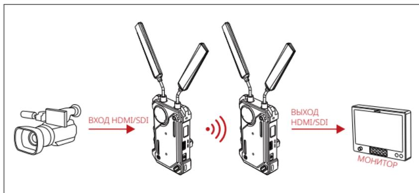
Примечание: передатчик может быть оснащен грибообразной антенной. При значительной разнице высот между передатчиком и приемником рекомендуется использовать грибообразную антенну Hollyland на передатчике для повышения стабильности беспроводной передачи.
