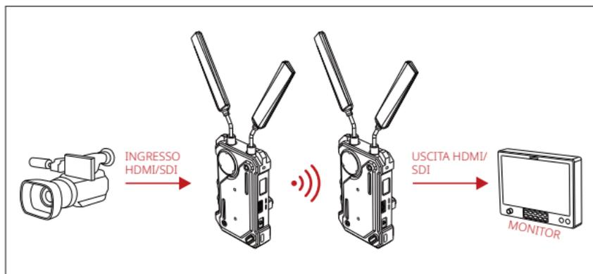
Avvertenza: Il trasmettitore può essere dotato di un'antenna a fungo. Se vi è una grande differenza di altezza tra il trasmettitore e il ricevitore, si raccomanda di utilizzare l'antenna a fungo di Hollyland sul trasmettitore per migliorare la stabilità della trasmissione wireless.
