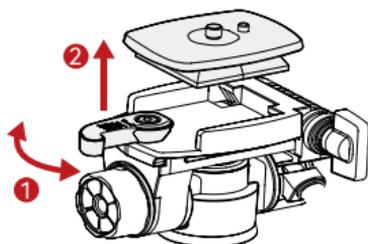
2. Befestigen Sie die Schnellwechselplatte an der 1/4-Zoll-Gewindebohrung der Kamera und rasten Sie die Platte anschließend in die Stativhalterung ein.
