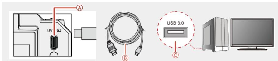
\*Hinweis: Bitte verwenden Sie das mitgelieferte USB 3.0-Kabel. Die Verwendung eines Kabels mit niedrigeren Spezifikationen kann zu einer fehlerhaften Videoausgabe führen.
