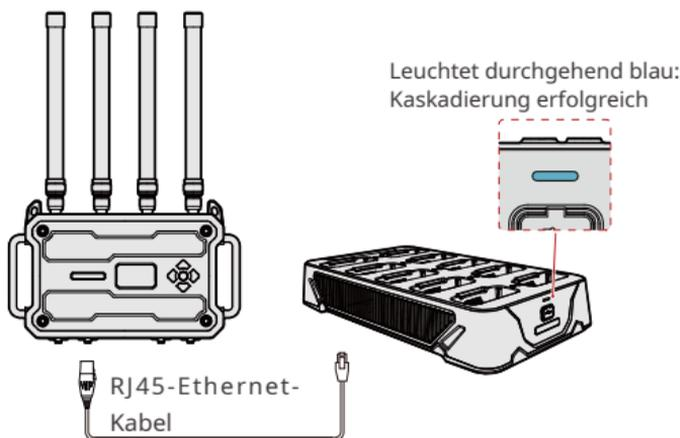
2. Setzen Sie das Beltpack senkrecht in die kaskadierte Ladestation ein. Nach ca. 3 Sekunden koppelt sich das Beltpack automatisch mit dem aktuellen kaskadierten System.
