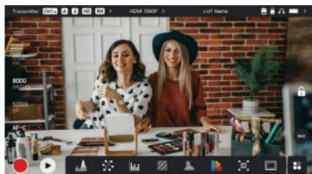
È possibile controllare la telecamera direttamente tramite lo schermo tattile, regolando dinamicamente otturatore, apertura, registrazione, messa a fuoco, bilanciamento del bianco e ISO.
