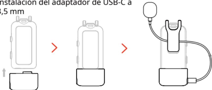
\*Asegure el cable del adaptador dentro del clip trasero del micrófono para evitar que se salga accidentalmente.
