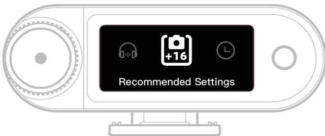
Il valore "+16" indica il livello attuale di guadagno in uscita del ricevitore della telecamera.
