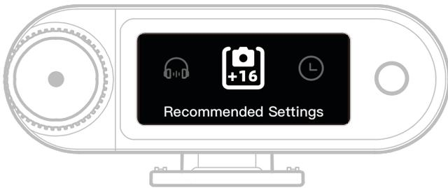
Der Wert „+16“ zeigt die aktuellen Ausgangsverstärkung der Kamera an.
