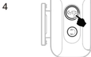
Чтобы выполнить сопряжение микрофона(-ов), выключите приёмник для камеры, а затем нажмите и удерживайте кнопку сопряжения в течение 6 секунд.
