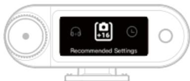
Значение «+16» указывает на текущее усиление выходного сигнала на приёмнике для камеры.
