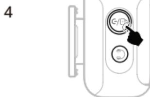
Para parear o(s) microfone(s), desligue o RX para câmera e pressione e mantenha o botão de pareamento por 6 segundos.
