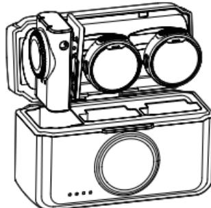
ステップ2：スマートフォンに受信機を接続し、送信機を取り出します。するとマイクの電源が入り、自動的に接続されます。使用準備が整っていると、送信機と受信機の青いライトが点灯します。
