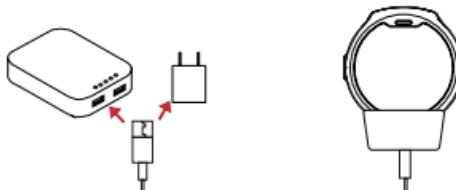
カメラバージョン受信機で両方のステータスインジケーターが赤の速い点滅に変化した場合、充電ケーブルで受信機を充電することができます。充電中はオレンジ色で点灯します。充電が完了するとライトが緑で点灯し、30分後に消灯します。
