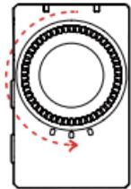
音量つまみを時計回りに 音量つまみを反時計回りに回すと、音量が上がります。回すと、音量が下がります。
