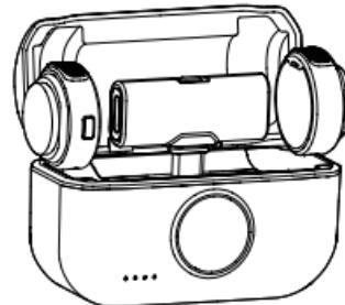
ステップ2：スマートフォンに受信機を接続し、送信機を取り出します。するとマイクの電源が入り、自動的に接続されます。使用準備が整っていると、送信機と受信機の青いライトが点灯します。
