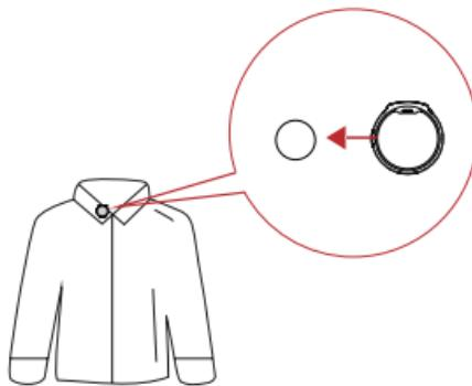
襟の背後にクリップマグネットを配置し、襟の前面に磁石で送信機を固定します。
